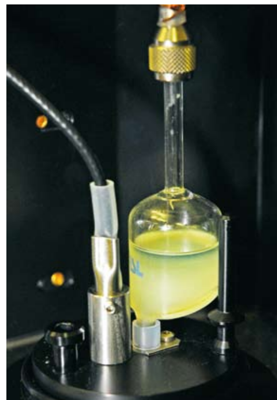
Hranice filtrovatelnosti se určuje opakovaným plněním a vyprazdňováním baňky podchlazenou naftou
